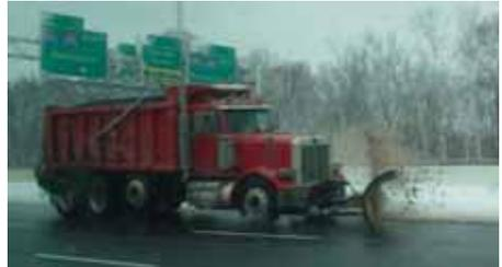
図-1 除雪兼凍結防止剤散布車(ワシントン)
