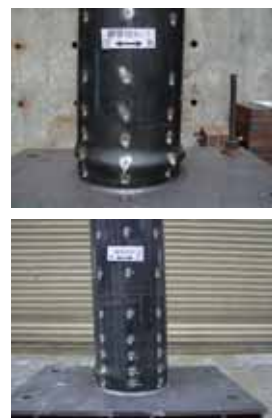
図4 荷重終了時の試験体の損傷状況
