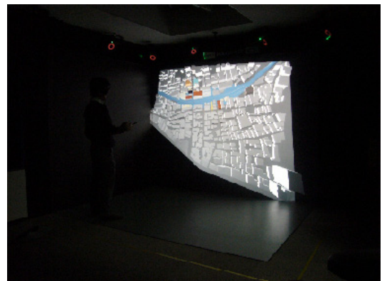
図-8 VR 空間の上空より洪水の浸水状況を確認している様子
