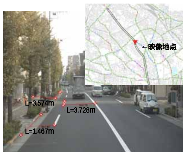
図3 GIS 道路データと三次元計測データとのリンク
