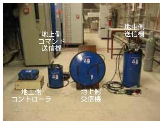
図-1 地中無線通信システム
