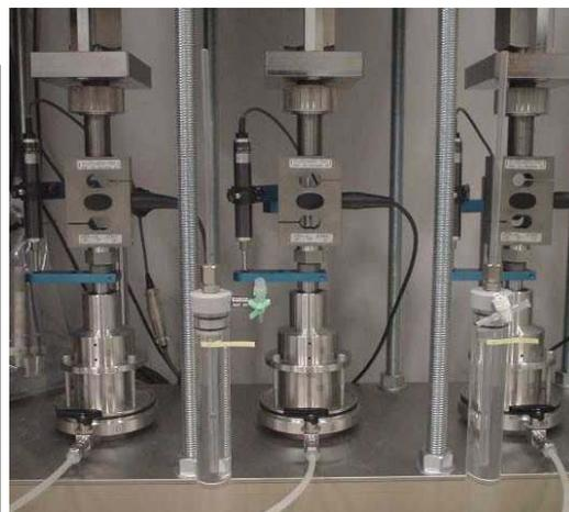
写真-1 荷重制御膨潤変形試験装置
