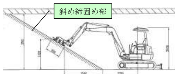
図-2 狭隘なトンネル埋戻しの締固め施工イメージ図
