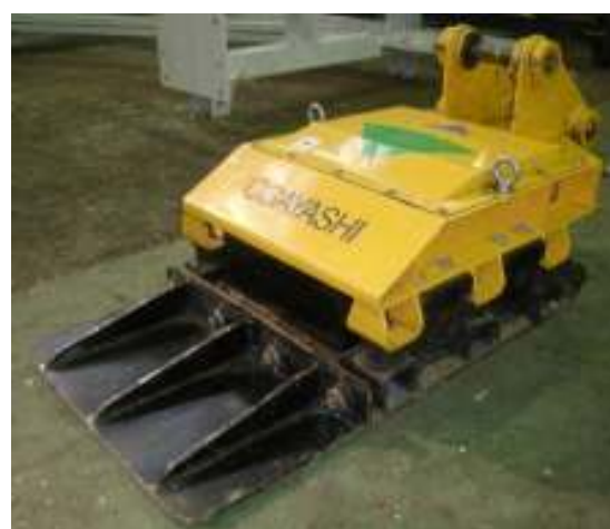
写真-1 先端部を改良した振動コンパクター
