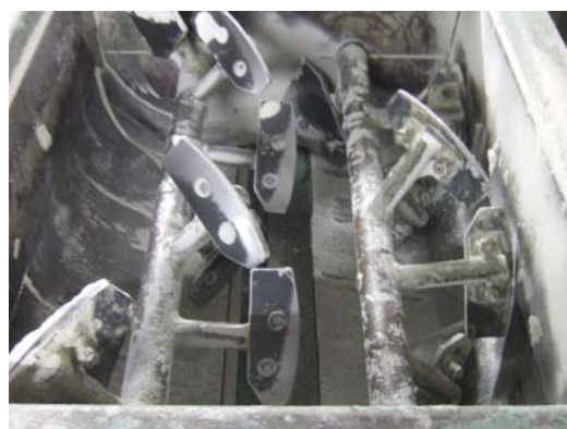
図-7 試験完了時のミキサ内部の状況
