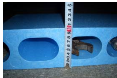
写真-2 ブロック高さ
