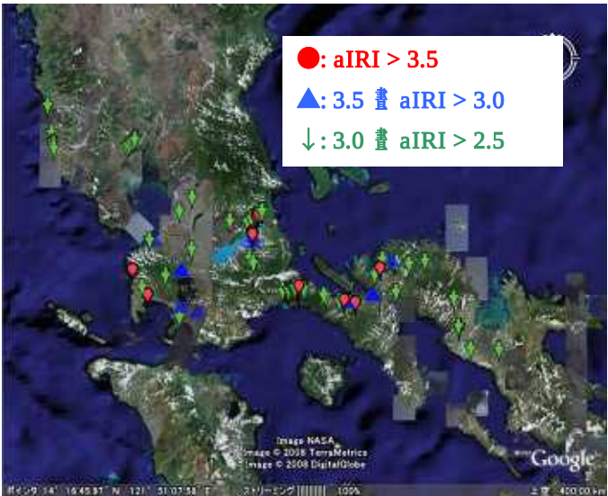
図2. ラフネス計測結果
