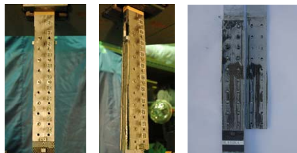
写真-2 リベット接着併用接合（RA-10列）における破壊状況
