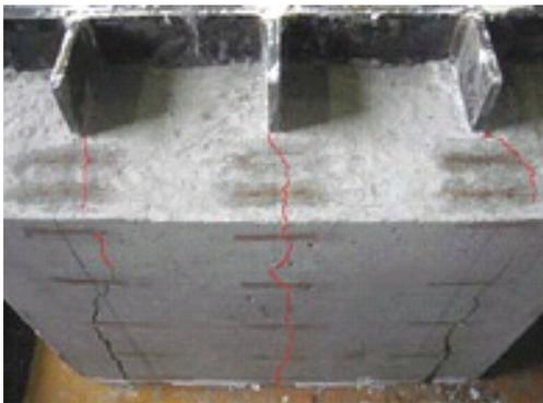
写真 - 1 ひび割れの様子 (S.T-B100-L200-H100-T No.2)
