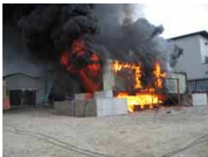
写真-1 加熱試験状況
