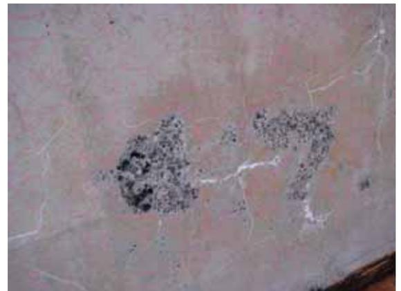
写真-2 試験後の床版のひび割れ状況
