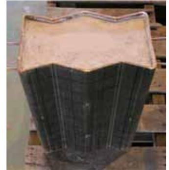
写真-1 波形断面合成柱
