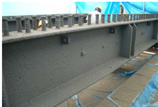
図 3.3 PBL 供試体(吹付け後)
