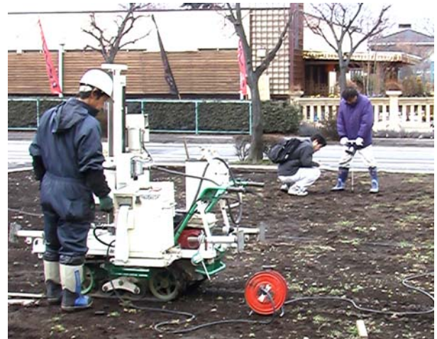
写真5 自動スウェーデン式サウンディング試験と鉄筋を用いた簡易判定法、簡易貫入試験等を比較検証
