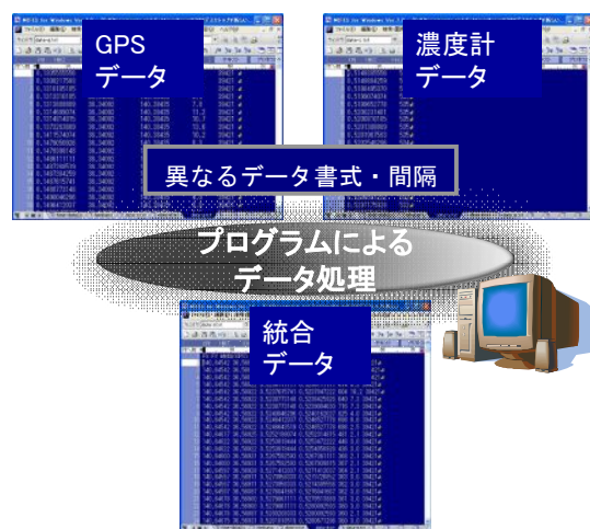
図-4 GPS と CO 2 濃度計のデータの統合
