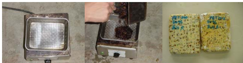
写真-1 ステンレス網 バット・ホットプレート 写真-2 溶融PET 写真-3 タイル ・ガラス
