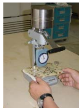
写真-4 デュロメータと定圧荷重器
