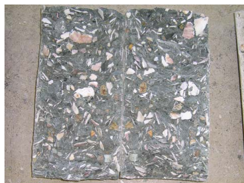
図-5 供試体の割裂状況
