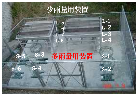
図 1 少雨量用と多雨量用の雨水採取装置
