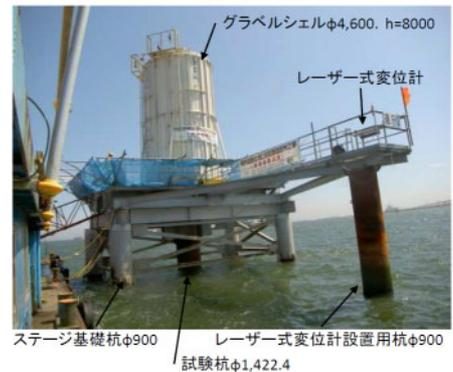
写真-1 急速載荷試験装置(F-2)
