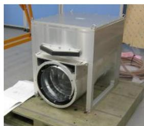
図-4 超音波式水中映像取得装置
