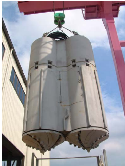
写真-1 浚渫機外観（2分の1モデル試験機）
