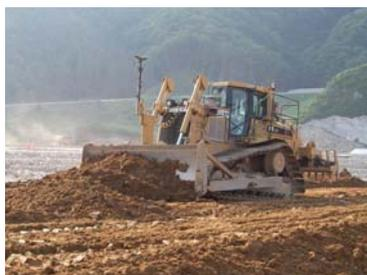
図-1 3D-MC ブルドーザ
