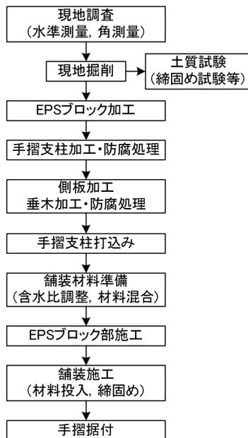
図-3 屋外歩行訓練施設の作製作業フロー
