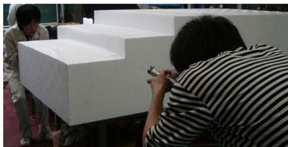
写真-2 EPSブロックの切り出し(階段)
