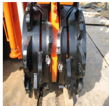
写真2-1 掘り残し部カッティング機構(揺動リングカッタ)
