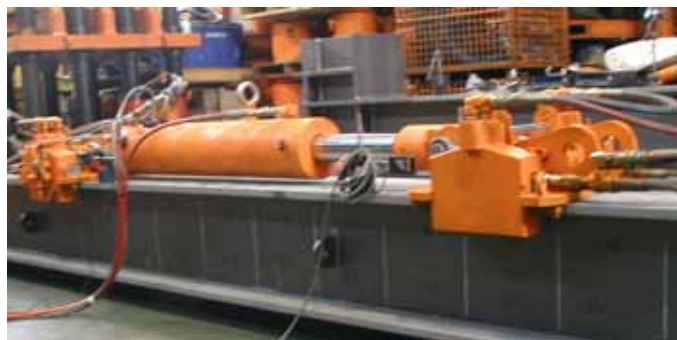
図-2 既存ジャッキの性能試験
