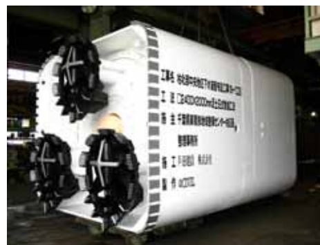
写真 - 2 矩形推進機全景
