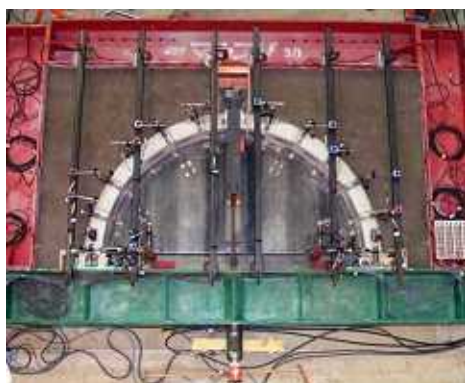
写真 - 1 1/4 モデル載荷試験状況
