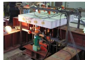
図3 静的載荷試験体と試験状況
