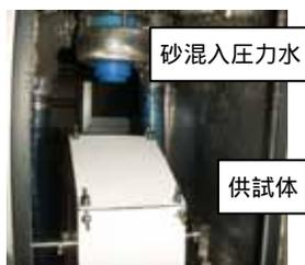
写真-1 摩耗試験状況
