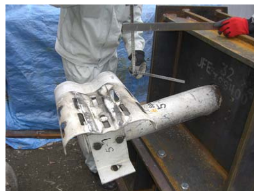
写真2.CASE4-2 試験後（変位量 48mm）
