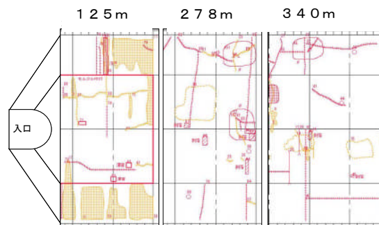
図-1. トンネル変状展開図
