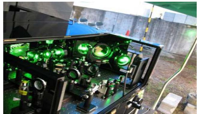
写真-1 コンクリート欠陥検出装置
