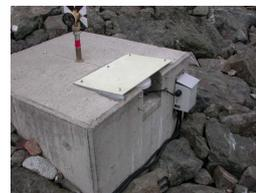
図-2 標的埋設型 GPS 設置構造図
