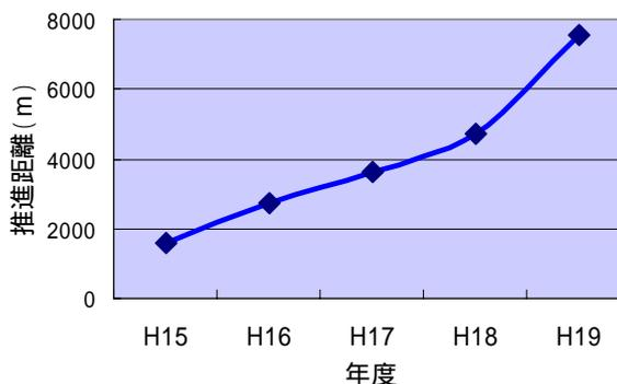
現在までに「prism」は、約60スパン、推進延長で約8kmの施工実績がある。その中の代表的な3事例としては、長距離(L=245m)、高深度(土被り26m)の曲線(R=150m)推進にて±20mmの精度、河川横断の曲線(R=100m, L=106m)推進にて±45mmの精度、電磁ノイズが激しい新幹線高架橋と並行する道路下曲線(R=300m, L=129m)推進にて±30mmの精度がある。
