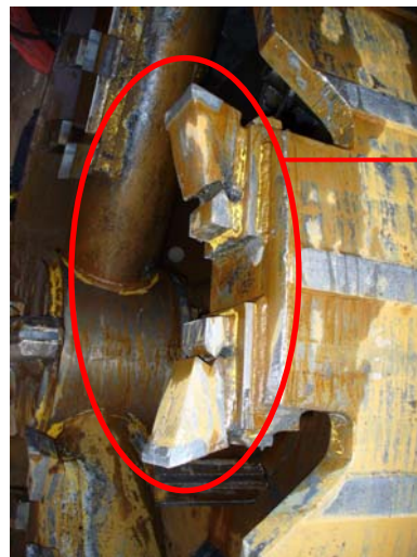
写真-5 二次ビット(全景)
