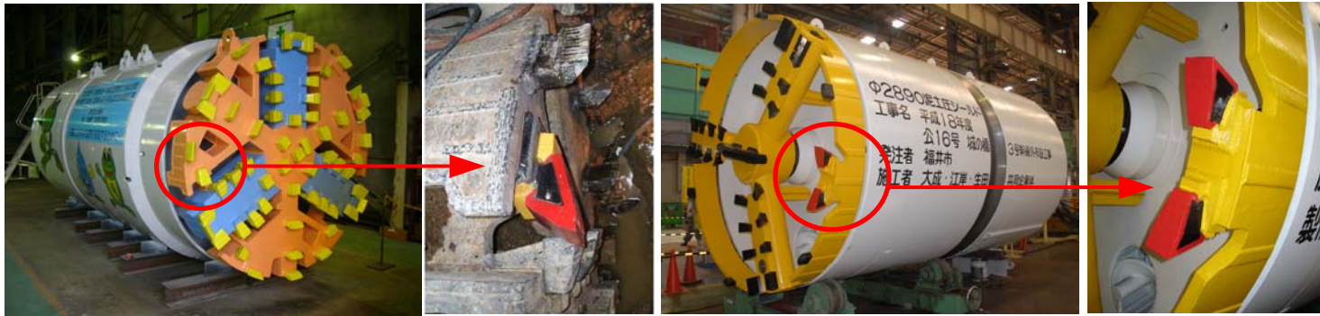
写真-2 実施工(試験施工)① シールドマシン及び二重ビット
