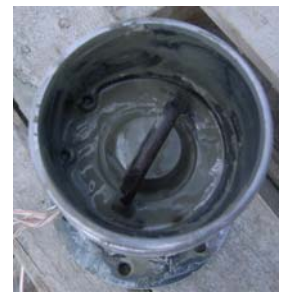
写真-3 注入後の弁体
