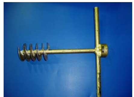
写真-4 裏込め材除去作業用工具
