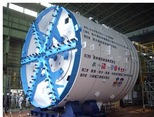
写真-1 φ6,940mm 泥土圧式シールド機
