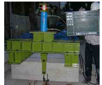
写真-2 せん断実験状況
