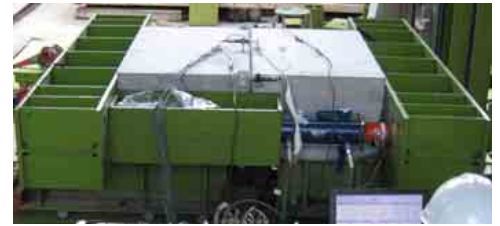
写真-1 リング継手引張実験状況
