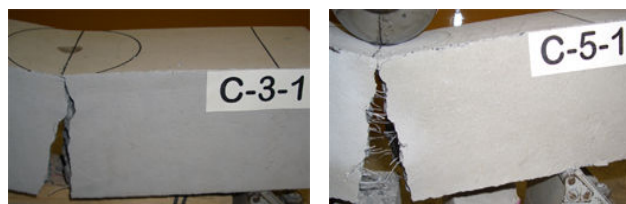
写真-1 破断直前の試験体のひび割れ状況
