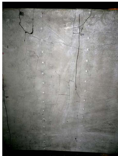
写真-3 破壊状況（内面側）
