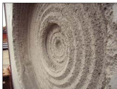
写真-2 切削跡 (ティースビット, タイプA)
