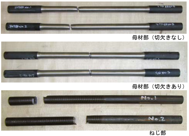
写真－1 破断状況
