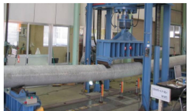
写真 2 曲げ強度試験状況
