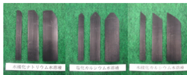
写真2 耐薬品性試験結果(目視観察結果)
