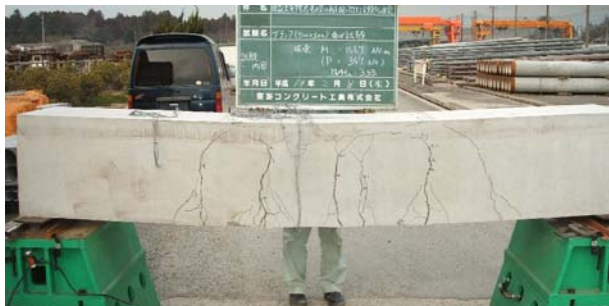
写真－3 破壊状況（標準タイプ）
