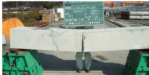
写真－4 破壊状況（継手タイプ①：ポリマー）
