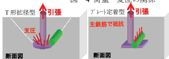
図-5 定着具の形状と反力媒体の相違
