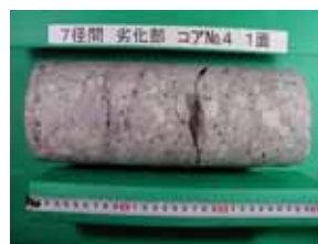
写真-5 コアの外觀変状
