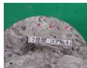
写真-5 コアの外觀変状
